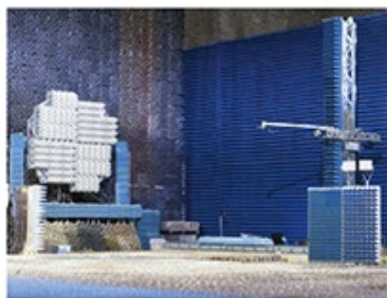
Рис. 4. ФАР в процессе калибровки в БЭК
